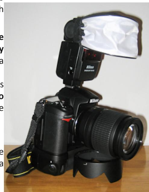
En comparación con los dos anteriores difusores, sí apreciarás **una mayor difusión de la luz** y, por tanto, la necesidad de emplear **una mayor potencia en el destello** para que el flash pueda iluminar correctamente la imagen.
