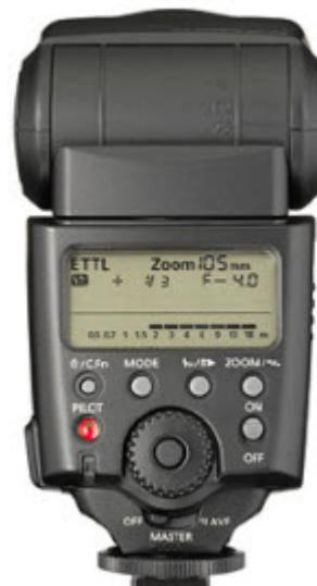
Las siglas TTL vienen del inglés Through The Lens (a través del objetivo). Y el nombre viene porque es a través del objetivo de la cámara por donde se realiza la medición del destello y se decide cuándo es suficiente para lograr una exposición correcta de la fotografía. **A diferencia del modo automático en que esta decisión la tomaba el propio flash.**
