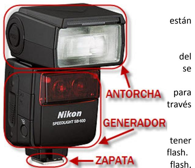
proporcionada por el generador. Para ello, la antorcha tiene un compartimento **lleno de gas Xenón** y dos diodos en los extremos, de manera que al establecer la suficiente diferencia de potencial entre éstos, hace que **salte una chispa y ésta, en contacto con el gas, genere el destello** tan característico de los flashes.
