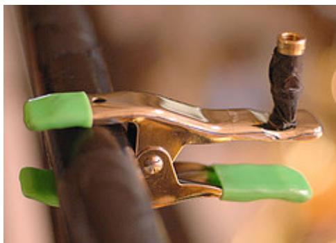
Usé las pinzas baratas de menos de 1€. Las modifiqué con unos tornillos y tuercas para conectar el adaptador que viene con la mayoría de soportes para flashes. Un poco de cinta aislante para darle rigidez y ya tenía un soporte capaz de sujetar mis flashes.
