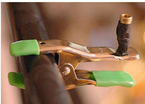
Usé las pinzas baratas de menos de 1€. Las modifiqué con unos tornillos y tuercas para conectar el adaptador que viene con la mayoría de soportes para flashes. Un poco de cinta aislante para darle rigidez y ya tenía un soporte capaz de sujetar mis flashes.
