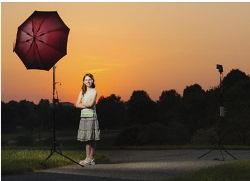
Si vas a utilizar una segunda luz, colócala en posición. Generalmente empleo un esquema de iluminación cruzada con la luz principal, empleando una fuente de luz dura y de muy baja potencia. No te olvides de ponerle un [gobo](#) al lado que apunta a la cámara para controlar los deslumbramientos.
