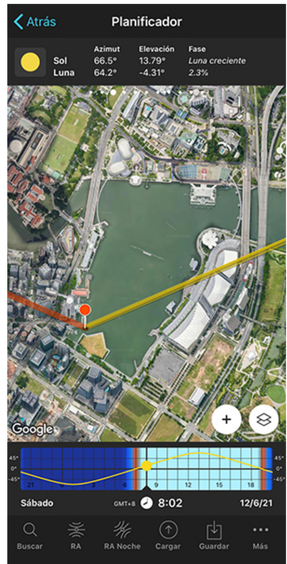
Planificador de PhotoPills - El Panel 3 indica la elevación del Sol (13,79°) para la posición del Pin Rojo, la fecha y la hora seleccionadas.
